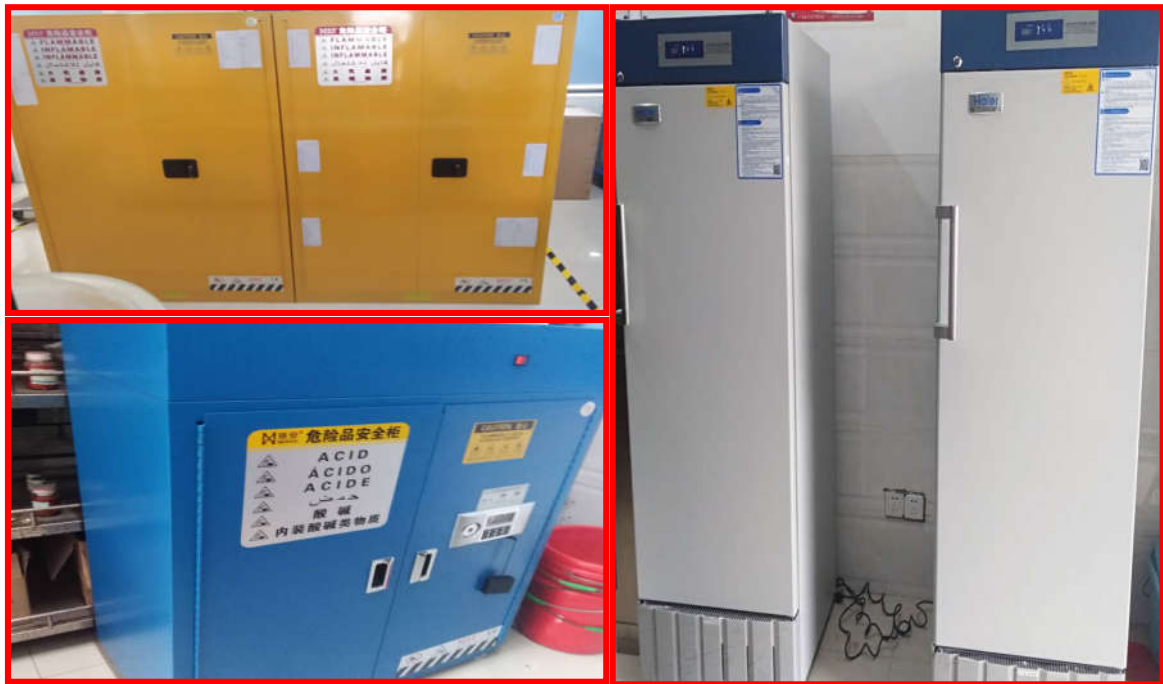
图3 安全设备（左上为安全柜、左下为高毒试剂保险柜；右侧为防爆冰箱
